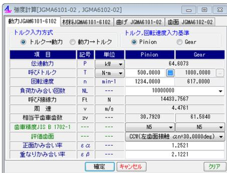
図 4.18 強度計算 (動力設定)
