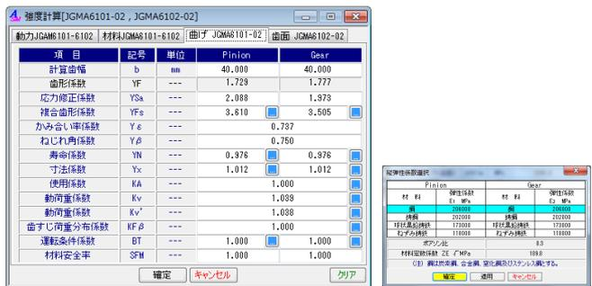
図 4.20 強度計算 (曲げに関する係数)
