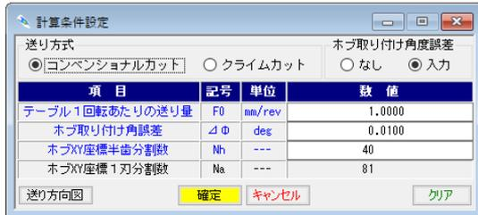
図 23.31 ホブ取り付け角度誤差の設定
