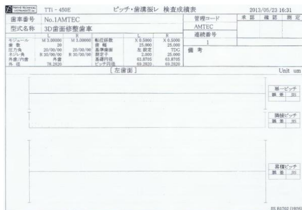
図 104.9 検査結果 (ピッチ誤差, 左歯面)
