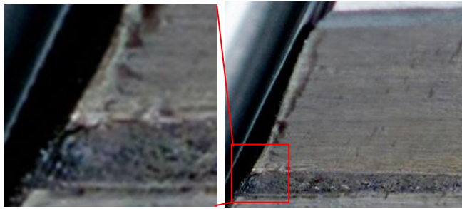
図 I.30 ギヤ歯面損傷端部拡大写真, 歯 14, N_p=1.0 \times 10^6
