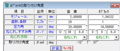
図 11.51 ホブの取り付け角度
