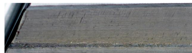
図 I.29 ギヤ歯面損傷 (10)
