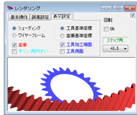
図 42.12 工具加工端面 (切り刃) と歯車
