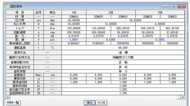
(各段の圧力角とねじれ角を変更した例)
