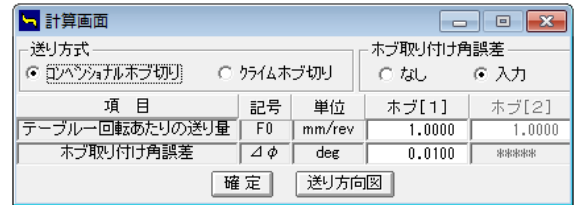
図 23.30 ホブ取り付け角度誤差の設定
