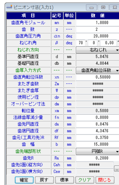
図 20.36 ピニオン諸元と寸法
