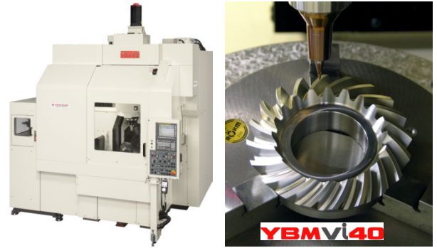
YBMVi40 ( m5, z20, \alpha20^\circ, \beta=35^\circ, d=100.0 )
