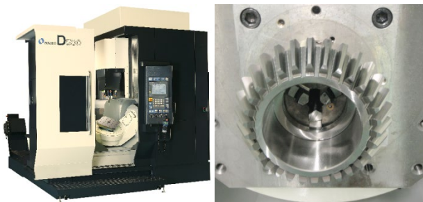
D500 ( m5, z30, \alpha20^\circ, \beta=0^\circ ) ((株)牧野フライス製作所様 ご提供)
