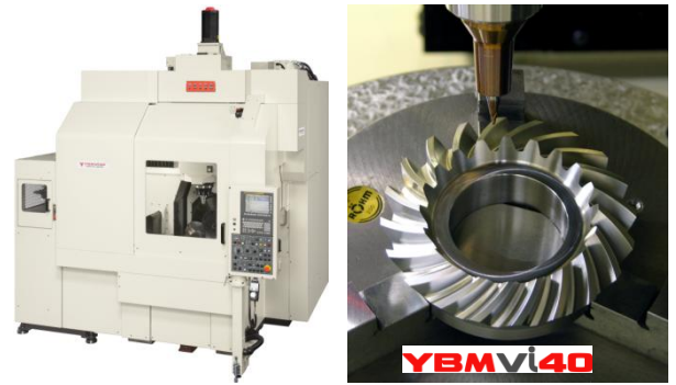
YBMVi40 ( m5, z20, \alpha20^\circ, \beta=35^\circ, d=100.0 ) (安田工業 株式会社様 ご提供) 図 2.77 スパイラルベベルギヤ加工例
