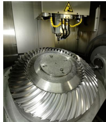
HERMLE C-50U ( m10, z47, \alpha20^\circ, \beta=35^\circ, d=470 ) (愛知産業 株式会社様 ご提供) 図2.78 スパイラルベベルギヤ加工例
