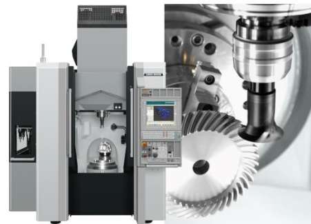
NMV3000 DCG ( m4, z40, \alpha20^\circ, \beta=35^\circ, d=160 ) (DMG 森精機 株式会社様 ご提供) 図 2.79 スパイラルベベルギヤ加工例
