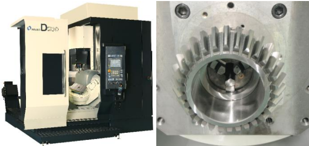
D500 ( m5, z30, \alpha20^\circ, \beta=0^\circ, d=150 ) (株式会社 牧野フライス製作所様 ご提供) 図 2.75 ストレートベベルギヤ加工例
