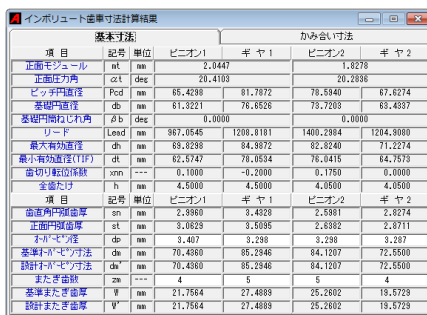
図 38.7 インボリュート歯車寸法（基本寸法）
