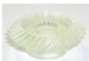
図 2.38 光造形モデル ( m1,z28,\alpha20^\circ,\beta35^\circ )
