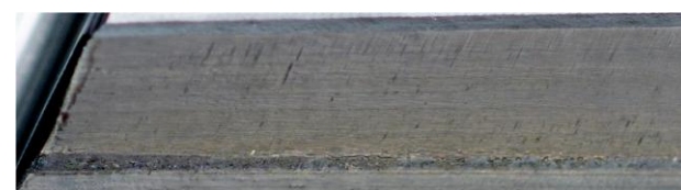
図 I.29 ギヤ歯面損傷 (10)
