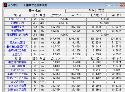
図 38.7 インボリュート歯車寸法（基本寸法）
