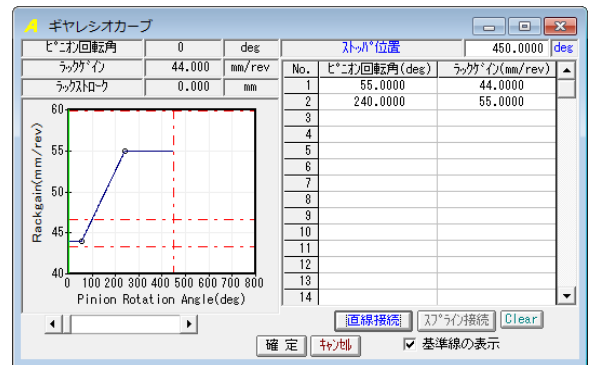
図 19.6 ギヤレシオカーブ(直線接続)
