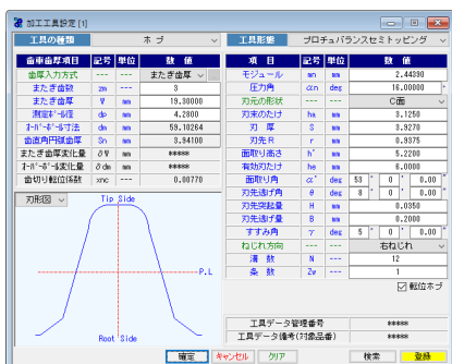
図 11.10 プロチュバランシングセミトッピングホブ (転位ホブ)
