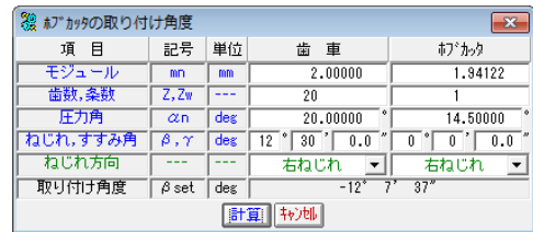
図 11.51 ホブの取り付け角度
