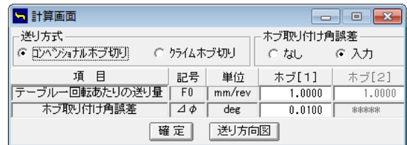
図 23.30 ホブ取り付け角度誤差の設定
