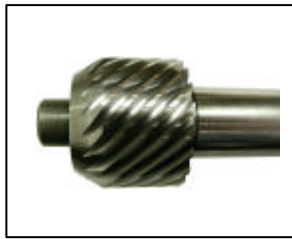
mn=1.25, Z=20, \alpha=20^\circ \alpha=45^\circ , 成形研削
