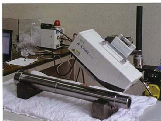
X線残留応力測定装置
