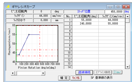
図 19.6 ギヤレシオカーブ(直線接続)
