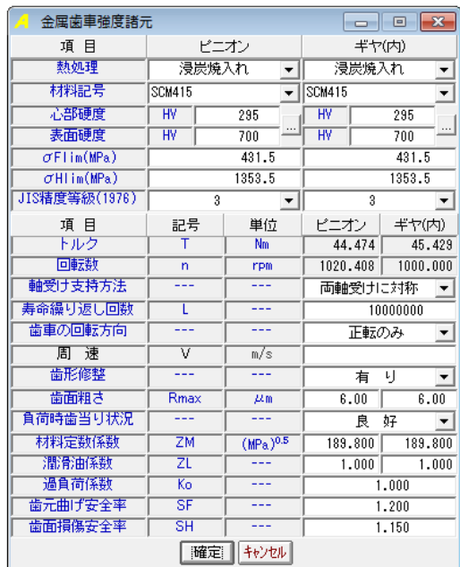
図 35.16 強度計算 (強度諸元)
