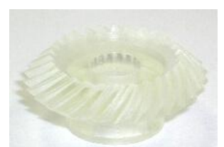
図 2.38 光造形モデル m1, z28, \alpha 20^\circ, \beta 35^\circ
