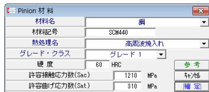
図 12.8 ピニオン材料の設定
