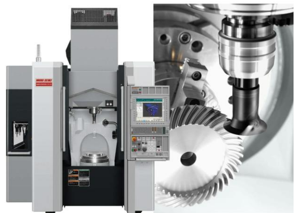
図 2.51 スパイラルベベルギヤ加工例
