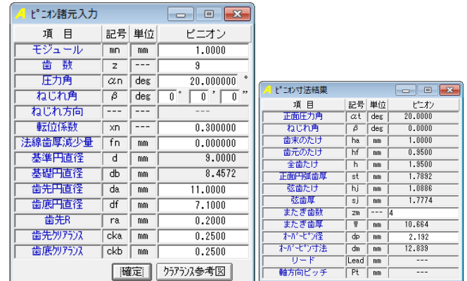
図 20.16 ピニオン諸元設定と寸法
