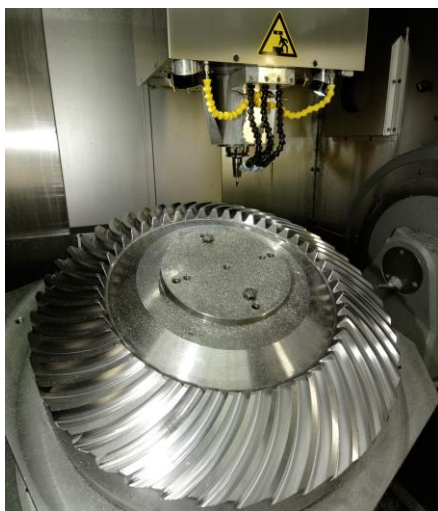
図 2.48 ストレートベベルギヤ加工例
