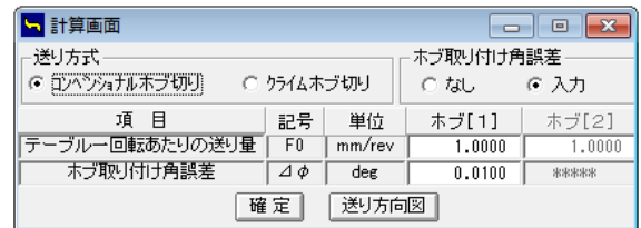
図 23.30 ホブ取り付け角度誤差の設定
