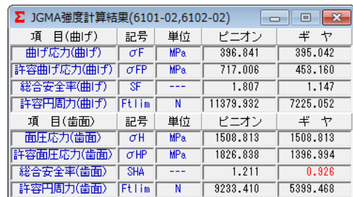
図 1.71 強度計算結果
