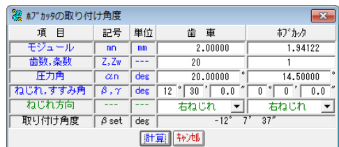
図 11.51 ホブの取り付け角度
